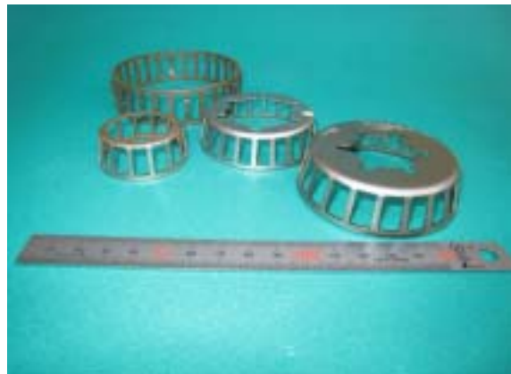
図2 ベアリングリテーナ (トランスファ金型内で総抜き)
